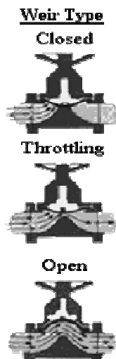
شکل ۲-۷ وضعیت عبور جریان در شیر دیافراگمی
