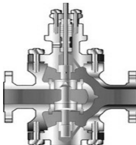
شکل ۲-۳: شیر دو نشیمنگاهی
